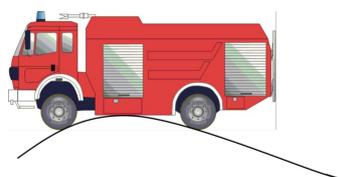
**Überhangwinkel:** Der Überhangwinkel ist der Winkel zwischen der Standebene des Fahrzeuges und einer Ebene, die den Umfang der Reifen der äußersten Achse und den äußersten tiefsten Punkt des Fahrzeuges berührt.
