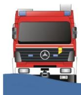
**Kippwinkel:** Der Kippwinkel ist der gemessene Winkel zwischen horizontaler Ebene und der Standebene, bei dem das um seine Längsachse gekippte Fahrzeug seine Stabilität verliert.
