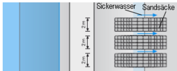
Stützung mit Sandsäcken ohne Sickerrost – Draufsicht
