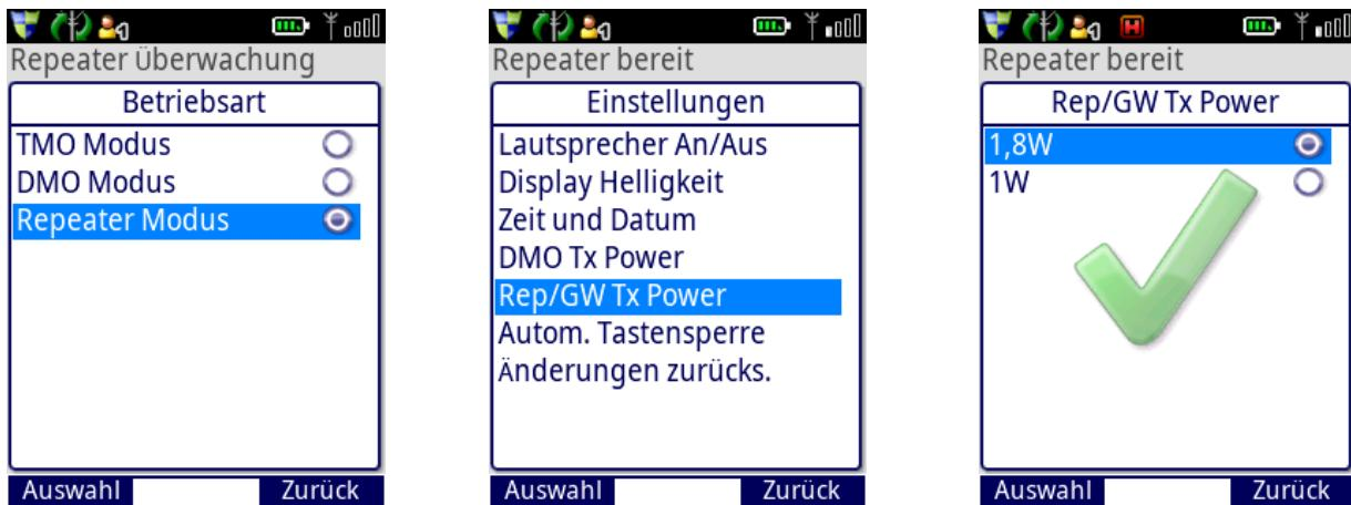
Sowohl beim „DMO Tx Power“ als auch beim „Rep/GW Tx Power“ wird bei einem Neustart des Funkgerätes die Sendeleistung automatisch auf die Standard-Sendeleistung zurückgesetzt.
